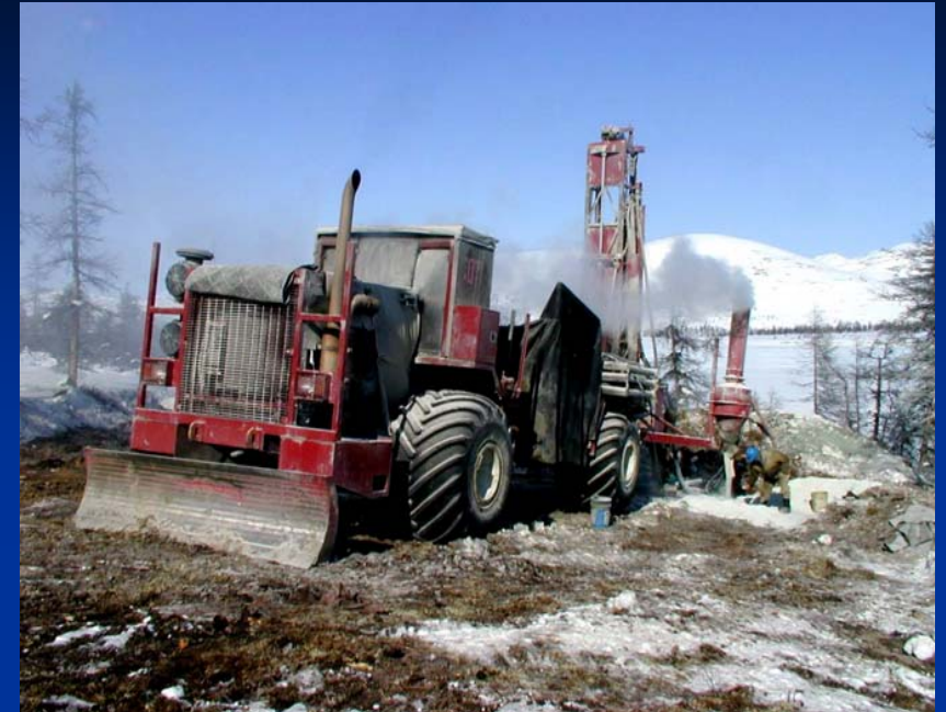
БУРОВОЙ СТАНОК ШЛАМОВОГО БУРЕНИЯ PROSPECTOR W-750
