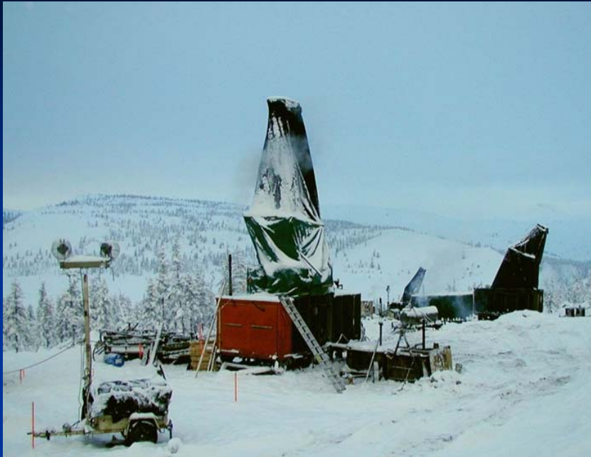
БУРОВЫЕ СТАНКИ КЕРНОВОГО БУРЕНИЯ LONGYEAR 70 и CS 1000
